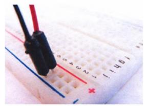
Рис 1:Соединение проводника к плате
