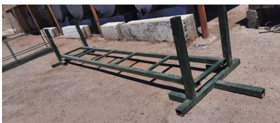
7-расм. Бир-бирига 30-40 даражали бурчак остида занжир ёрдамида уланган кўзгалувчан кўприк.
