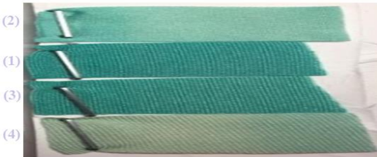
Расм-1. Нейлон/эластан матосини диамидофосфат металл фталоцианин пигментида бўяш:
