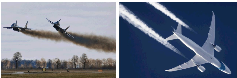
Рисунок 18. Примеры демаскирования летательных аппаратов в видимом диапазоне спектра струями выхлопных газов, содержащие сажистые частицы и воду
