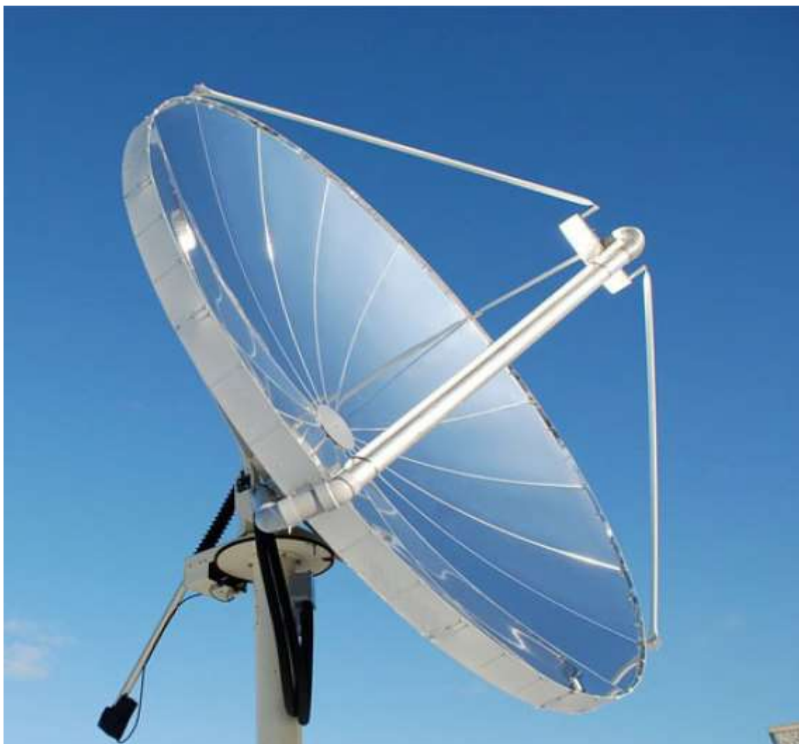
3-rasm. Paraboloidsimon konsentratorlar
