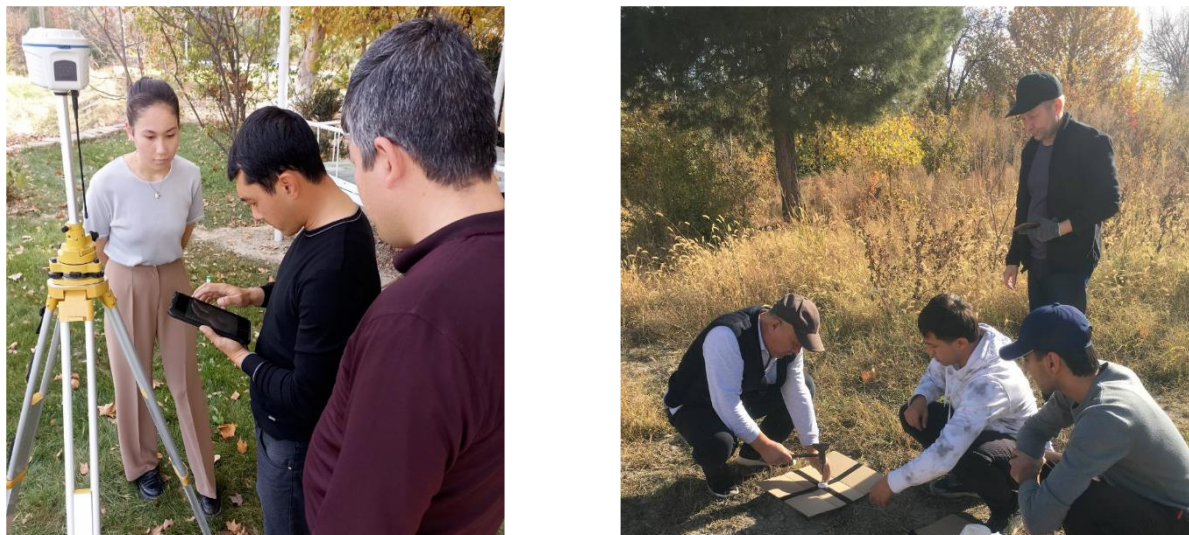
Рис. 2. Закрепление опорных знаков и пунктов съёмочного обоснования на местности.
