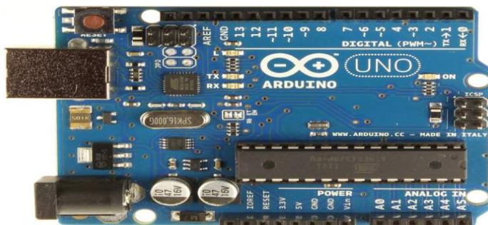
1-rasm. Arduino Uno – ATmega328 mikrokontrolleri
