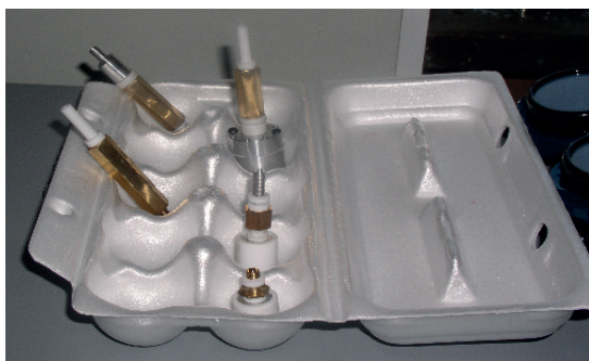
Рис. 2. Минирезонаторные кюветы с образцами
