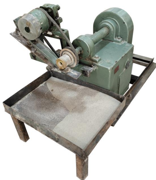
3-rasm. Materiallarni abraziv muhitda yeyilishga sinash qurilmasi
