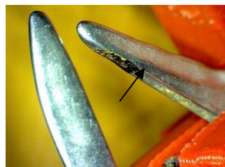
Рис. 2. Износ внутренних контактных поверхностей зубьев батана
