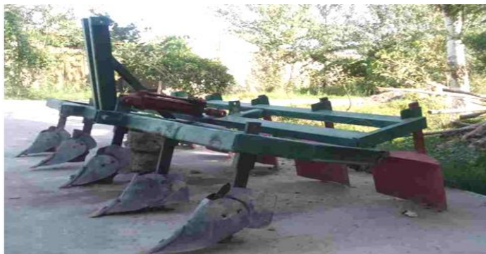
Рис. 1. Устройство для формирования поперечных почвенных валиков в междурядьях
