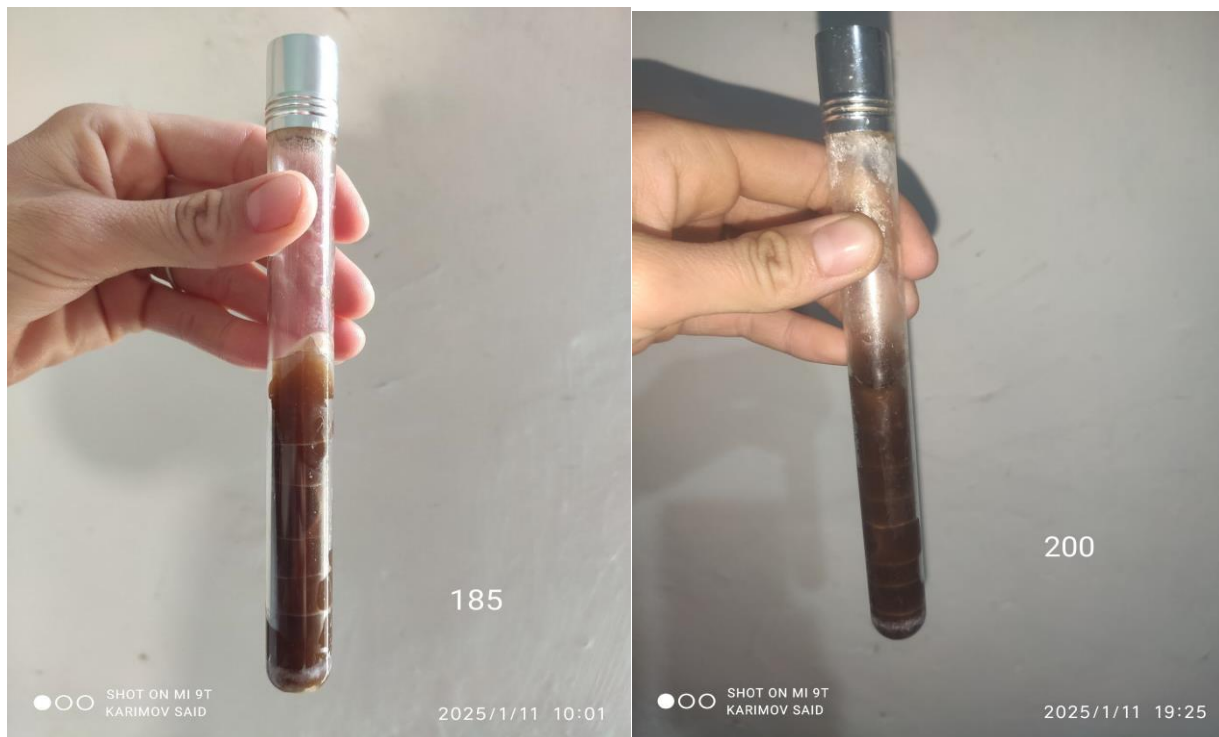
7-rasm. Faza o‘zgaruvchi material (parafin) ning barqarorligini aniqlash ichun o‘tkazilgan termal sikl jarayoni ko‘rinishi ; 185-sikl va 200- sikl.
