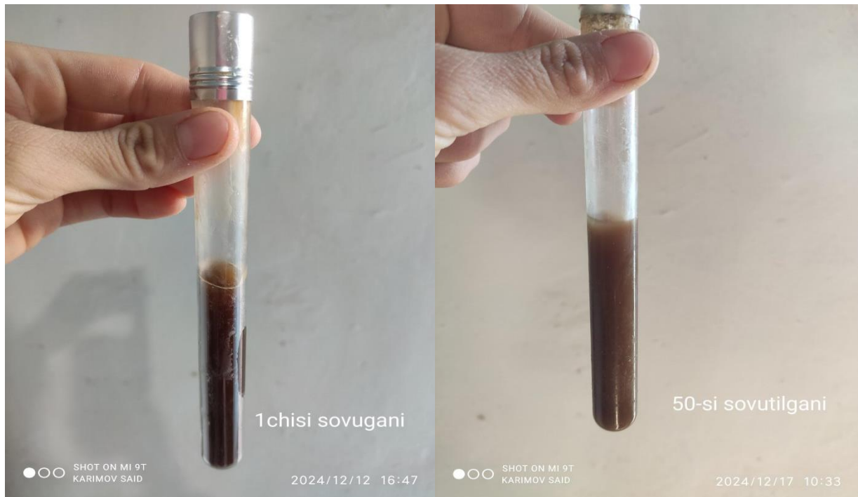
5-rasm. Faza o‘zgaruvchi material (parafin) ning barqarorligini aniqlash ichun o‘tkazilgan termal sikl jarayoni ko‘rinishi ; 1-sikl va 50- sikl.
