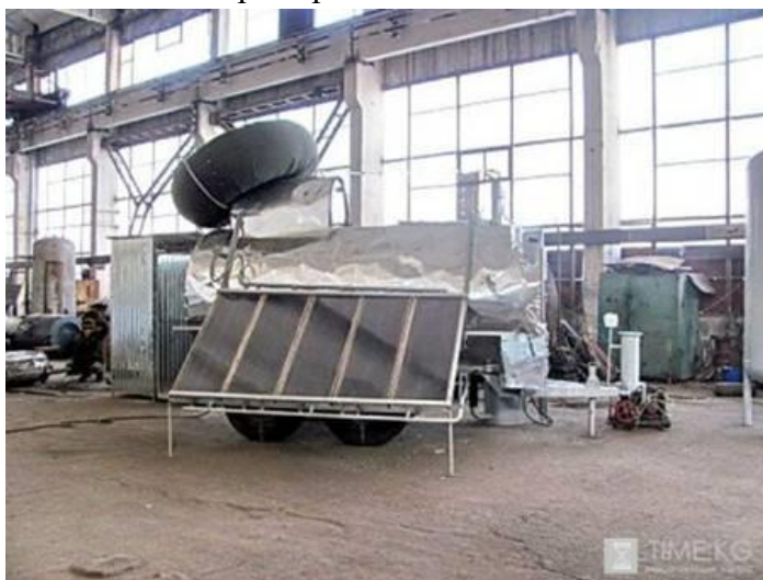
Рис.1 Гибридная биогазовая установка (с использованием солнечных батарей)
