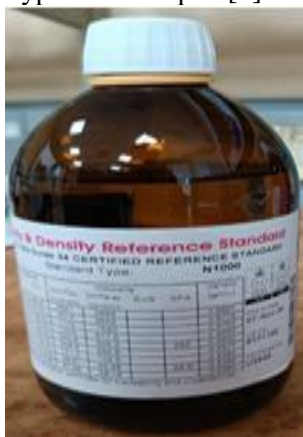
4-расм. ISO 17034 га мувофиқ сертификатланган зичлик стандарт намуналари (метрологик кузатувчанлик таъминланган)
