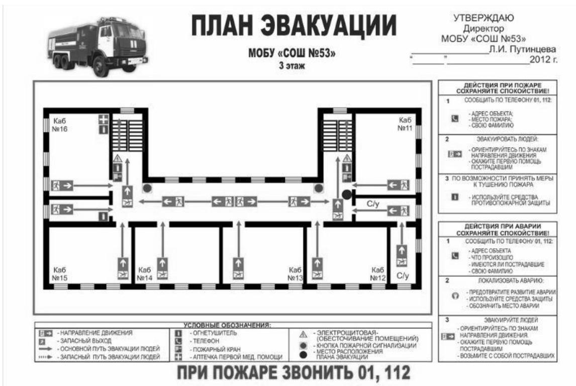
Рисунок 2. План эвакуации
