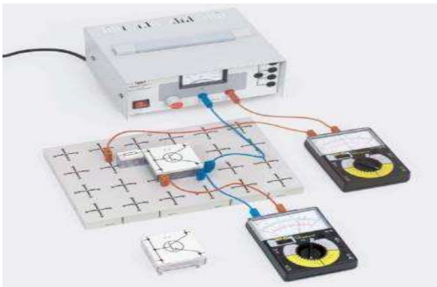
Рис. 2.3. Экспериментальная установка для исследование диодных свойств транзисторов.
