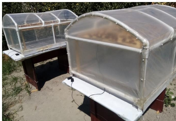
1-rasm. Eksperimental qurilmalarning tajriba jarayonidagi umumiy koʻrinishi (rasmda chapda oddiy polietilen qoplamali, oʻngda funksional keramika kompozit polietilen qoplamali quritgich)
