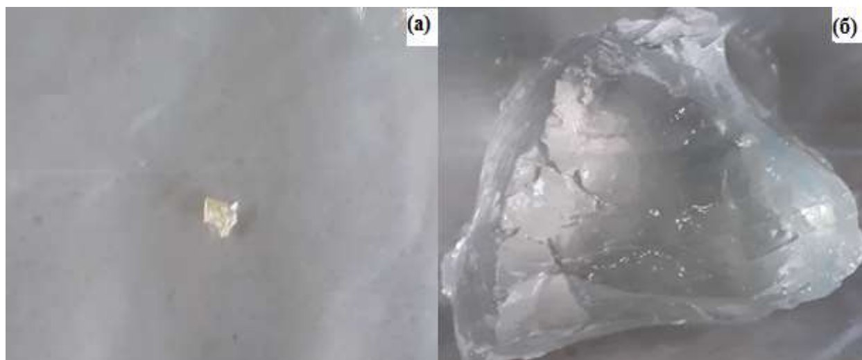
Расм 1. Қуруқ (а) ва бўккан (б) ҳолдаги крахмал/акриламид/бентонит асосли гидрогелининг фото сурати.
