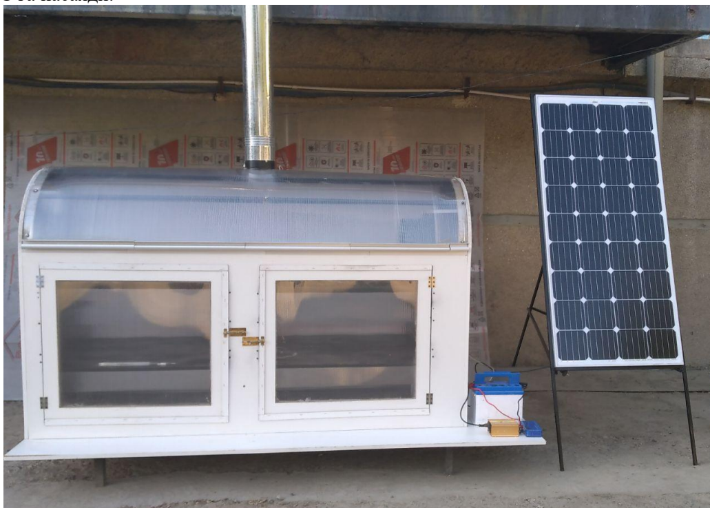
2-расм. Рециркуляцияли ихчам гелиоқуритгичнинг ташқи кўриниши
