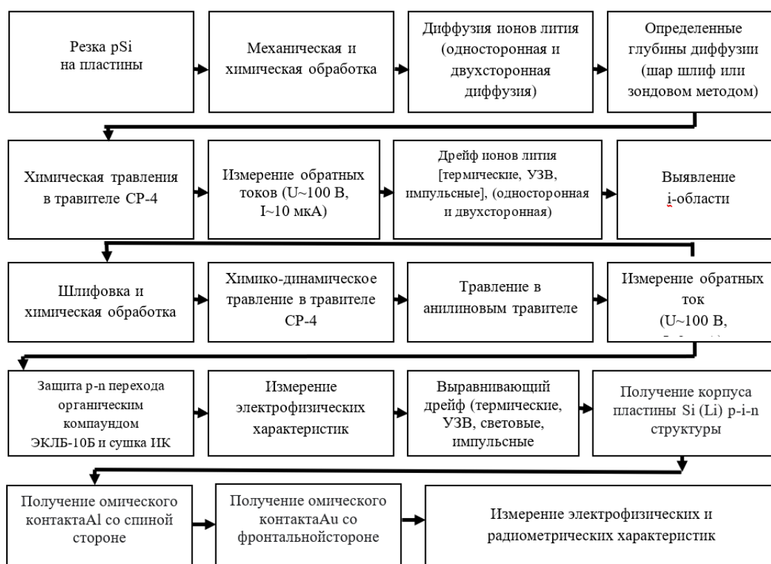
Рис. 2. Технологическая маршрутная карта изготовления Si (Li) детекторов для разработки портативного дозиметра
