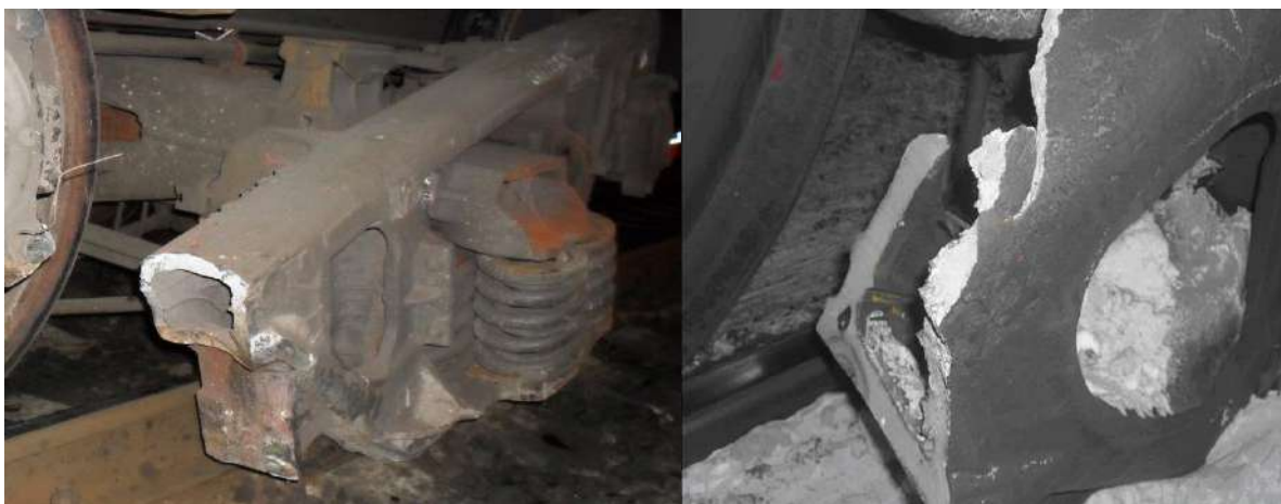
Рисунок 1 – Излом боковой рамы
