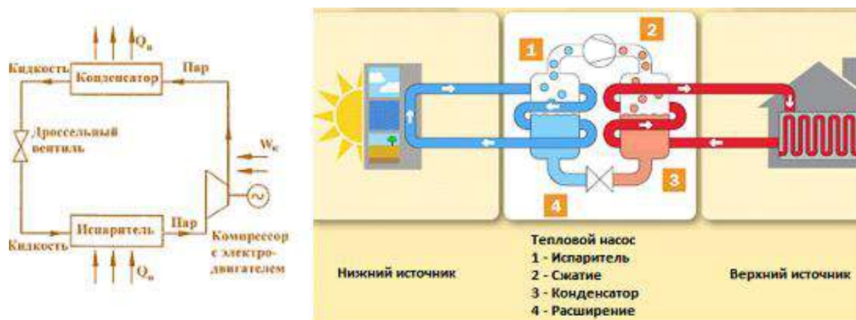
Рисунок 1. Устройство и принцип работы теплового насоса
