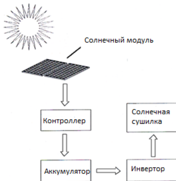
Рис.2. Блок-схема автономного электропитания сушилки.
