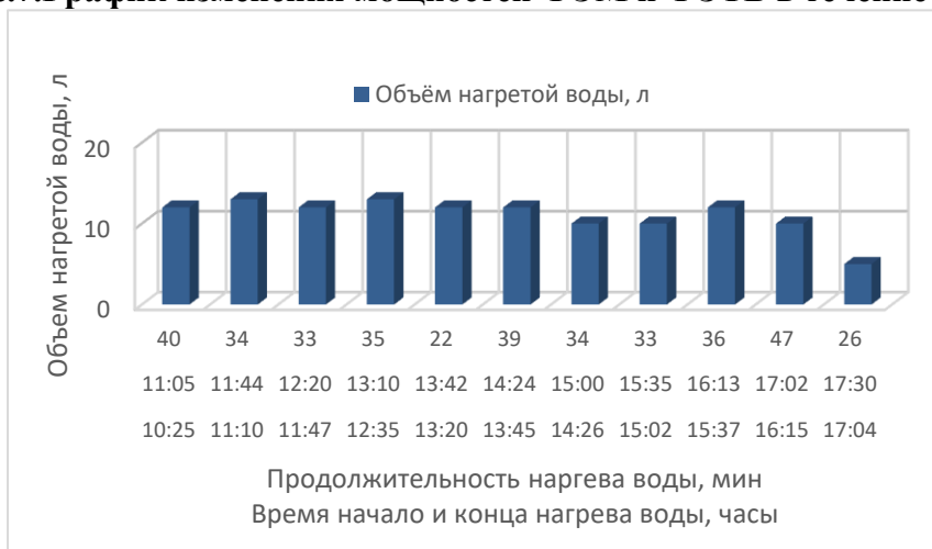
Рис.8.Диаграмма зависимости объема нагретой воды от времени нагреха холодной воды.
