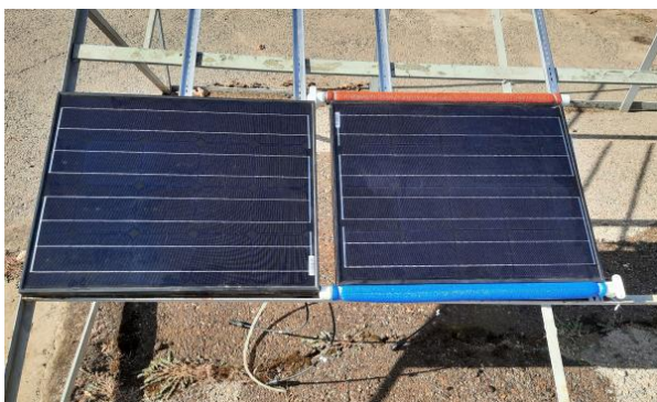
1-расм. ФЭБ ва ФИБ ни ҳаво ва сув орқали совутиш жараёни.
