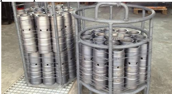
3.3-rasm Azotlanadigan detallar solingan konteyner
