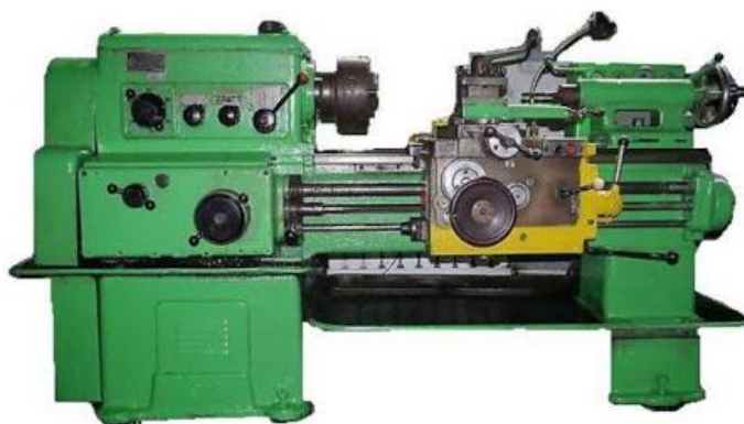
10.x -rasm. Tokarlik vintqirgish stanogining umumiy ko'rinishi
