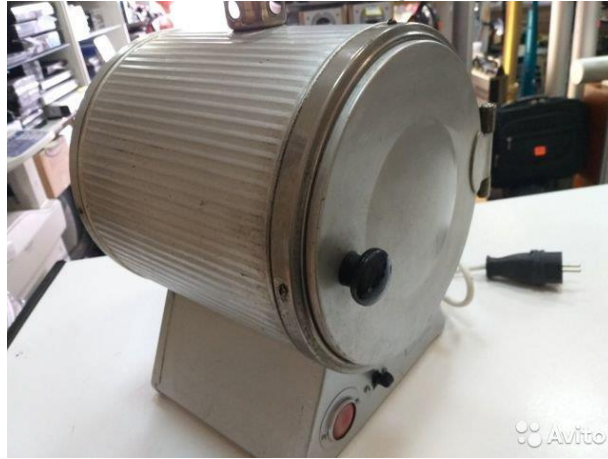
2.5 – rasm Mufel pechi umumiy ko'rinish
