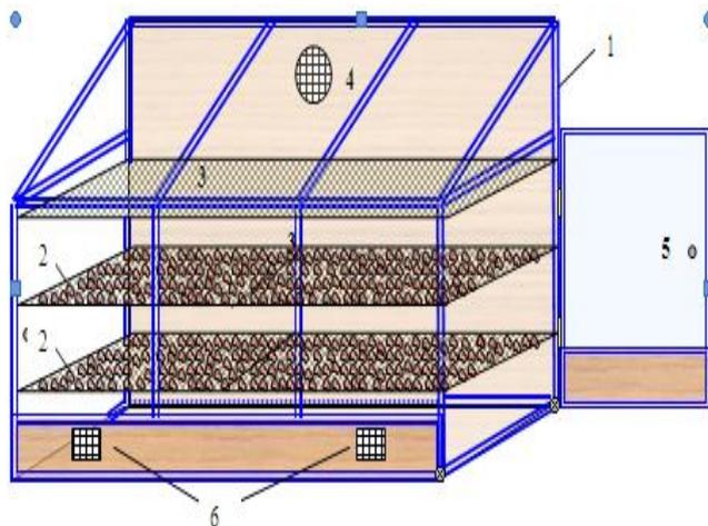
**Рисунок 1. познакомить учащихся со схемой инновационной солнечной мини-сушилки для фруктов и овощей. 1-стеклорамное окно; 2-местная стойка; 3-теплорастворяющее верхнее окно; 4-вытяжной вентилятор; 5-дверный со стеклянной рамой; 6-сетчатое окно воздухозаборника.**
