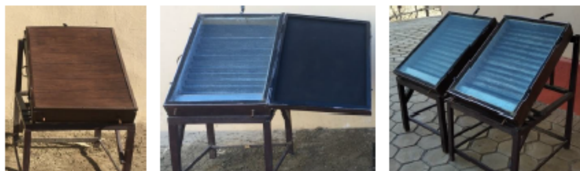
Рис.2. Общий вид переносного солнечного наклонно-ступенчатого опреснителя в виде чемодана.
