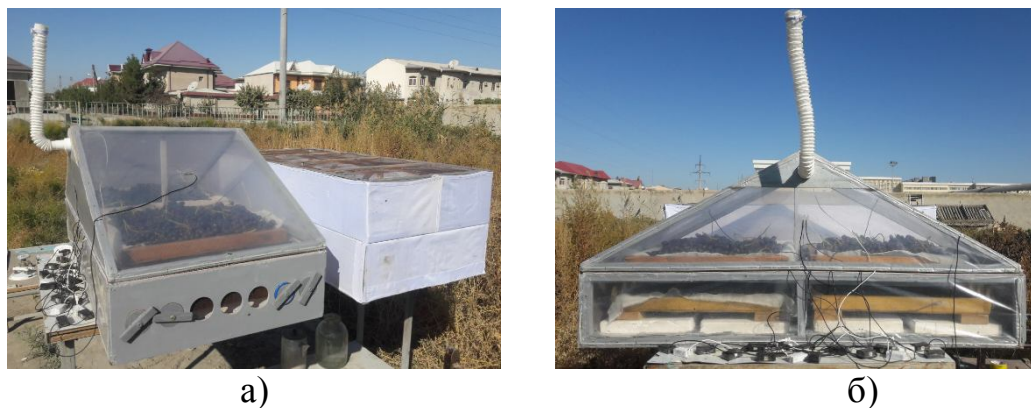
Рис.1. Натуральное изображение солнечной сушилки:
