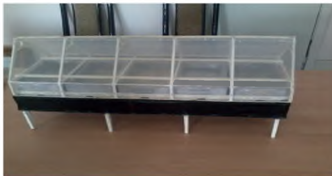
1-расим. Парникли куёш сув чучутгичининг лаборатория кўриниши.
