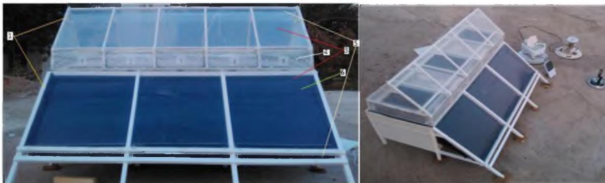
1 рис. Естественный вид солнечной сушилки фруктов парникового типа. 1- верхний и нижний корпус сооружения, который изготовлен из деревянного каркаса. 2-стены трёх сторон сооружения (поверхность, которая проводит свет) 4-посуда из нержавеющей стали и сделанная из дерева, куда помещаются фрукты 5-щели, которые служат для образования естественной конвекции. 6- коллектор, который служит для ускорения естественной конвекции.
