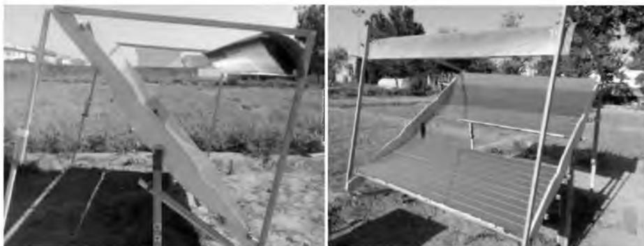
*Рис. 2. Внешний вид параболоцилиндрического концентратора*
