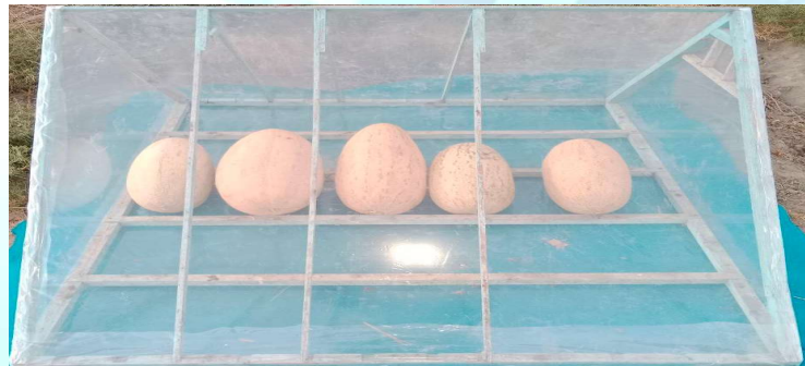
Рис.1. Парниковая солнечная установка для предварительной обработки дыни.
