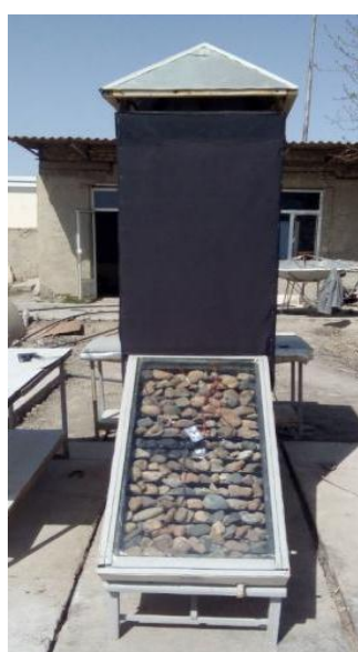
1-rasm. Tabiiy konveksiyali bilvosita quyosh quritgichi: a) qurilmaning umumiy ko'rinishi; b) prinsipial sxemasi
