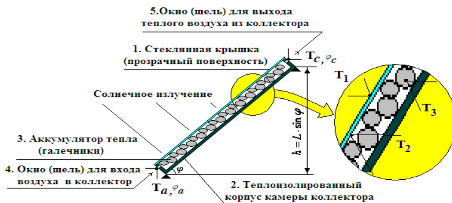
Рис.1. Принципиальная схема солнечного коллектора, предназначенного для косвенной осушки материалов: h – высота щели для выхода тёплого воздуха, L – длина коллектора, \varphi – угол наклонной поверхности дна коллектора по отношению горизонта, T_1, T_2, T_3, T_c, T_a – точки измерения температур, S_{in} – , S_o – окна (щели) для входящего и выходящего воздуха
