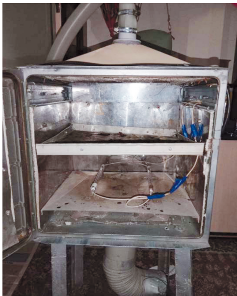
Рис. 5. Конвективная сушильная установка (с галогеновыми лампами инфракрасная кварцевая КХС 750 Вт, общая длина 224 мм, диаметр 10 мм, общая мощность печи 1500 Вт) с принудительной вентиляцией воздуха Fig. 5. Convective drying installation (with halogen lamps, infrared quartz KHS 750 W, total length 224 mm, diameter 10 mm, total oven power 1500 W) with forced air ventilation
