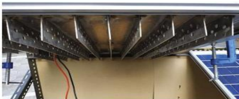
3-rasm. Radiatorlarni qo'llash orqali havoli FEMni sovitish usuli
