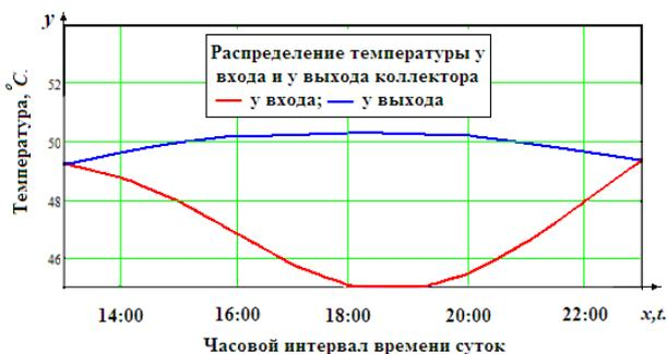
Рис.8. Распределение температуры в начале и в конце коллектора в конце дня.
