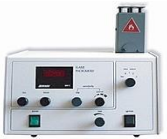
29-rasm. Yorqinli fotometr Karla Seysa, Germaniya Yorqinli fotometr PFP-7, Kiev
