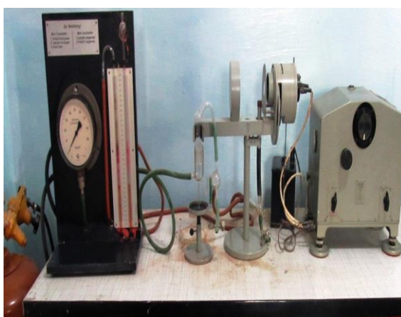
29-rasm. Yorqinli fotometr Karla Seysa, Germaniya Yorqinli fotometr PFP-7, Kiev
