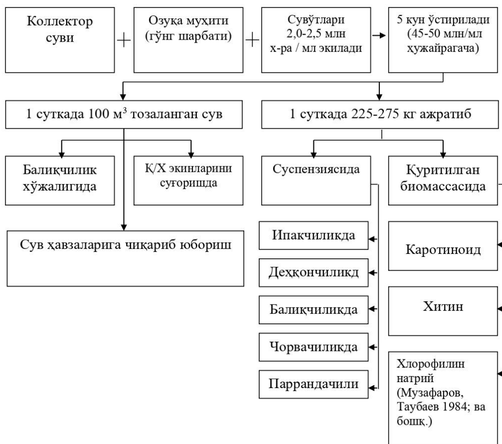
1-расм. Бухоро вилояти коллекторларидан ажратиб олинган Ch. pyrenoidosa ва S. obliquus ёрдамида тозаланган коллектор сувларининг ва унда этиштирилган сувўтлари биомассаларининг халқ хўжалигида ишлатилиш схемаси
