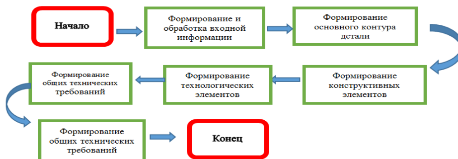
Рис.2. Алгоритм автоматизированного проектирования детали.
