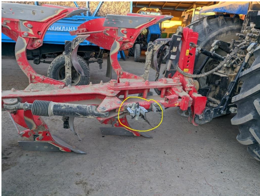
4-rasm Datchiklarni aylanuvchi pulug ramasiga joylashtirish
