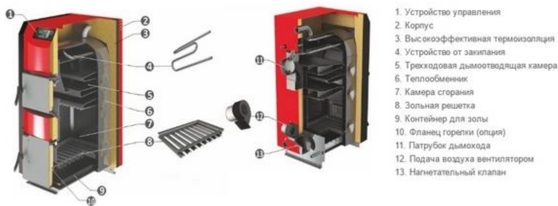
Рис.1. Устройство универсального твердотопливного котла с естественной тягой
