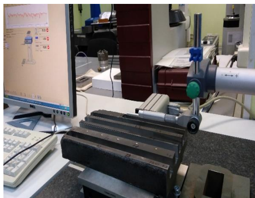
Рис. 3. Получение профилограммы профиля поверхности
