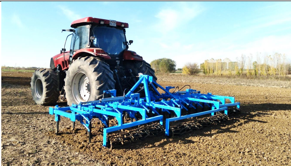
2-расм. “Рута” трактори ва асосланган параметрларга эга бўлган мослама билан жиҳозланган кенг қамровли чизел-култиватордан ташкил топган агрегатнинг иш жараёнидаги кўриниши
