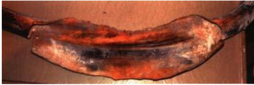
Рис. 1.3. Общий вид продольного разрыва поврежденной трубы
