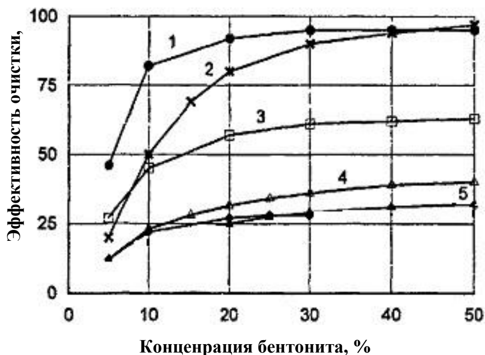
Рис. Влияние концентрации бентонита на эффективность очистки производственных сточных вод: 1 – окраска по разбавлению; 2 – ХПК; 3 – взвешенные вещества; 4 – анионные ПАВ; 5 – неионогенные ПАВ
