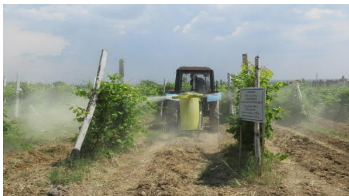
Рис. 1 Опыливатель ОШУ-200М в агрегате с трактором Беларусь 82.1 в работе (вид сзади).
