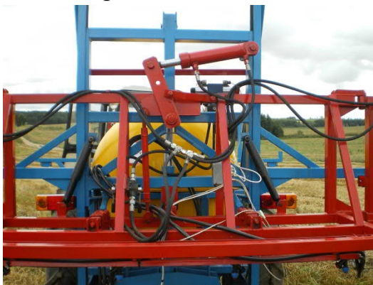
Рисунок 4 - Узлы системы СМАР после установки на опрыскивателе [4]
