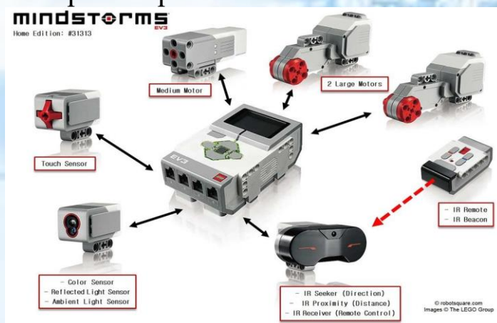
3.7-Rasm. Lego Mindstorms to'plamiga kiruvchi EV3 mikrokontrolleri
