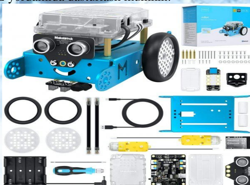
10.2-Rasm. Makeblock mBot core Coding Robot Kit to'plami umumiy ko'rinishi
