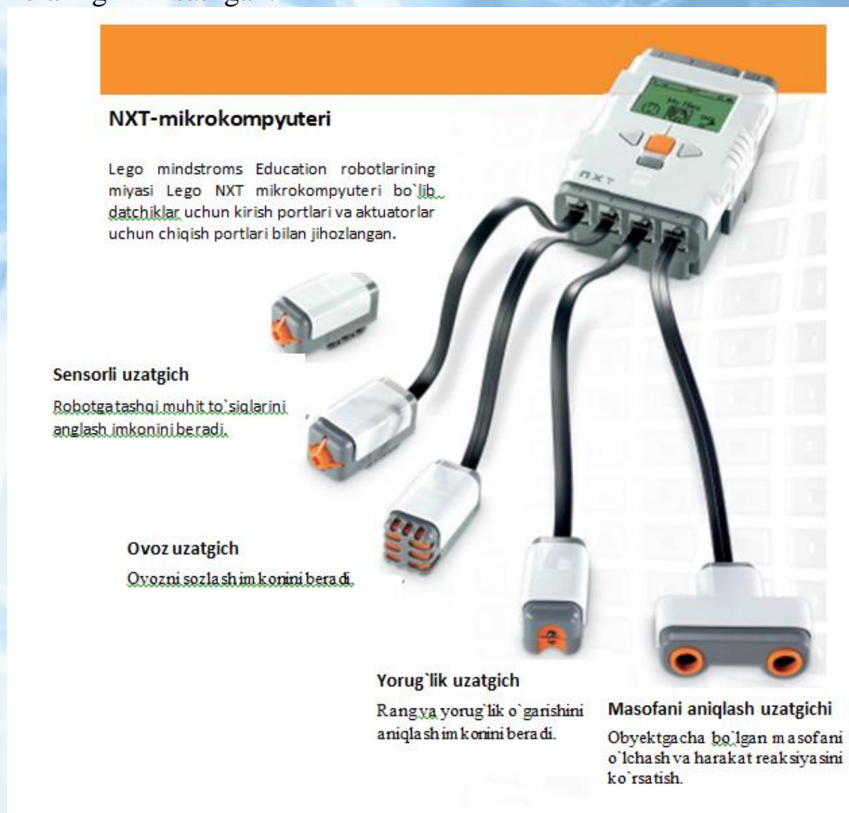
4.3-Rasm. Lego NXT mikrokompyuteri tuzilishi
