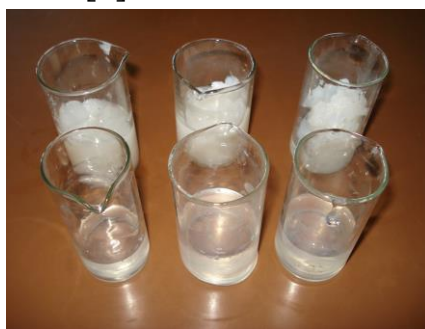
Рис. Охлажденные гели окисленного (нижний ряд) и нативного (верхний ряд) крахмала (полученные соответственно из 5, 6, 7 % ных клейстеров)
