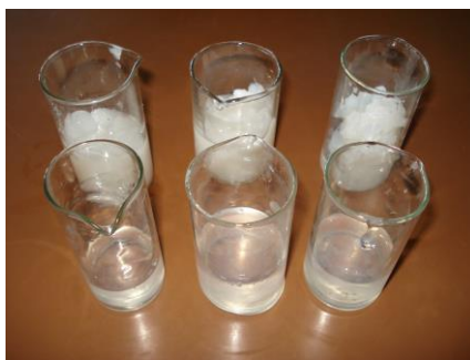
Рис. Охлажденные гели окисленного (нижний ряд) и нативного (верхний ряд) крахмала (полученные соответственно из 5, 6, 7 % ных клейстеров) (рисунок).
