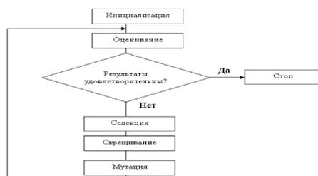
Рис. 1. Схема работы генетического алгоритма
