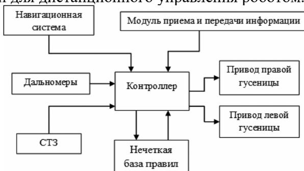
**Рисунок 1. Структурная схема транспортного модуля**
