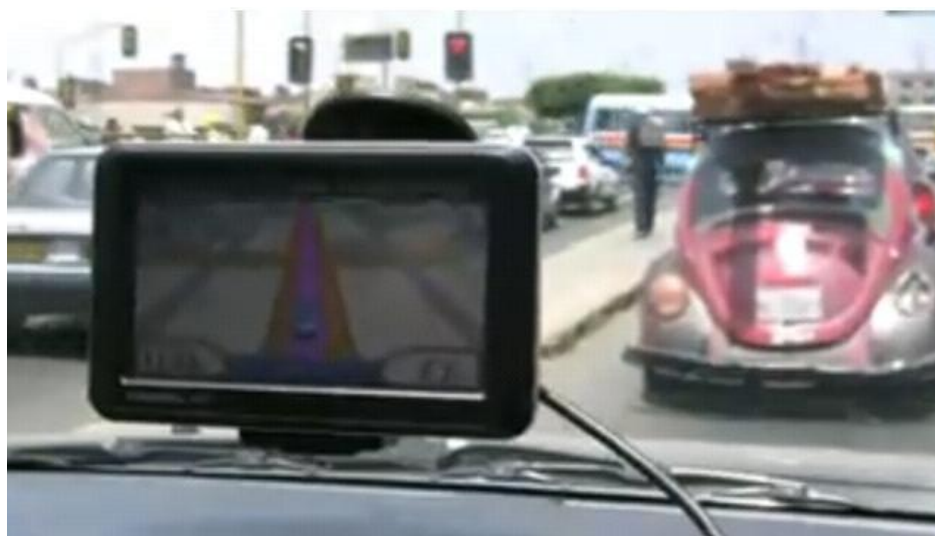
7.12.-rasm. GPS-qabul qiluvchi, o'rnatilgan va sun'iy yo'ldosh bilan to'g'ridan-to'g'ri o'zaro bog'lanadi.
