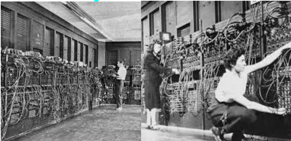
2.6-rasm. “Eniak” (Electronic Numerical Integrator and Computer) nomli birinch elektron raqamli kompyuter
