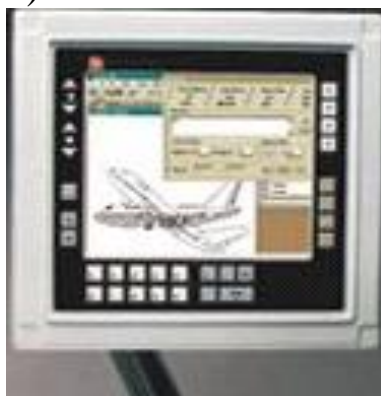
2.18-rasm. Operatsiya xonalari, yoki raketa, samolyot va vertolyotlarda, suv ostida, yoki murakkab holatlarda va xavfli vaziyatlarda maxsus kompyuterlar
