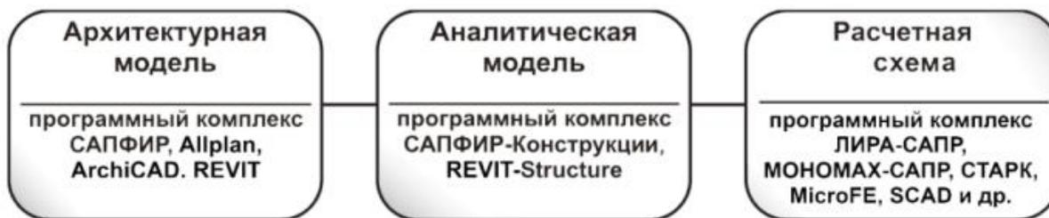
Рисунок 3. Обобщенная схема преобразования архитектурной модели в расчетную модель
