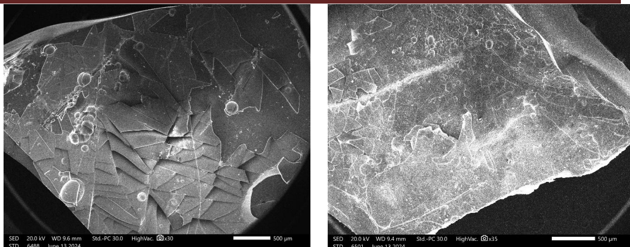
2-rasm. Kiyoviy tahlillar uchun tanlab olingan 2 va 9-shisha namunalarining Skanerlovchi Elektron Mikroskop (SEM-EDS) da olingan tasviri
