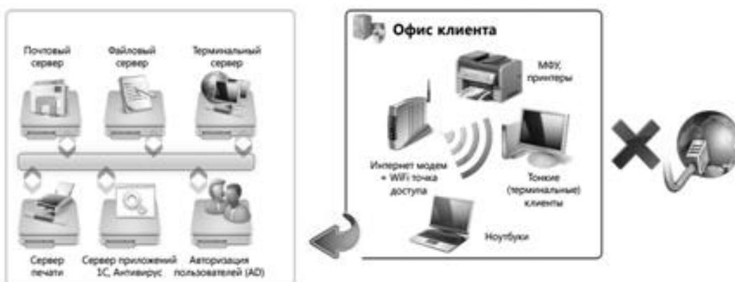
Рисунок 7. Закрытая модель частного «облака»
