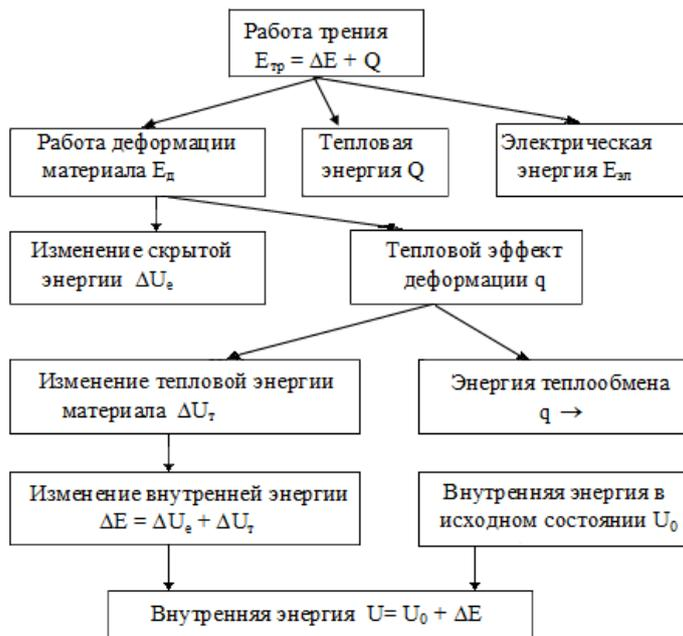
Рисунок 2. Схема энергетического баланса процесса трения и изнашивания
