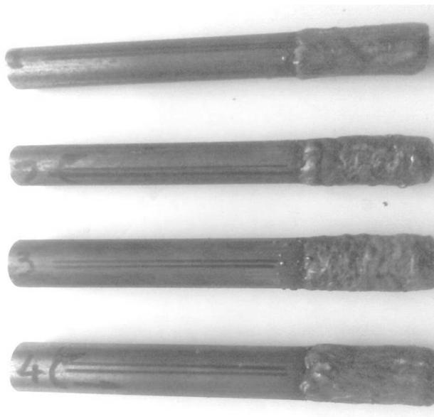
*Рисунок 4. Внешний вид полученного покрытия*
