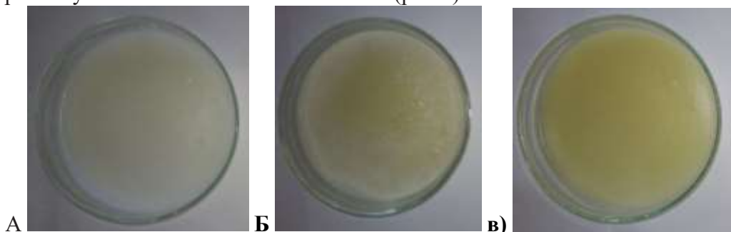
Рис.1. Пленки составов ОК-ПАА- \text{Na}_2\text{SiO}_3 полученного в разных растворителях а) пропаноле б)диоксане и в)этилацетате
