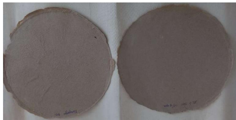
Рис.2. Картонные образцы полученные из макулатуры пропитанные (А) импортным kleем и (Б) разработанным kleевым композицией на основе окисленного крахмала
